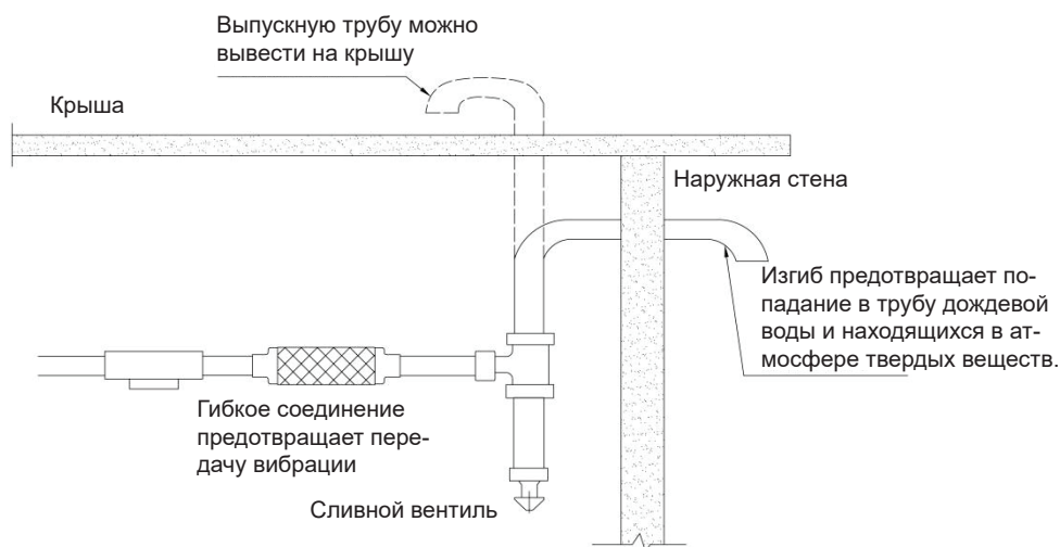
Рисунок 3.7. Подсоединение выпускной трубы предохранительного клапана
