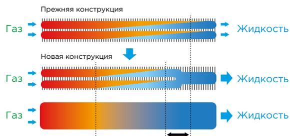
Газообразный хладагент конденсируется быстрее и дополнительно переохлаждается на 6 °C
