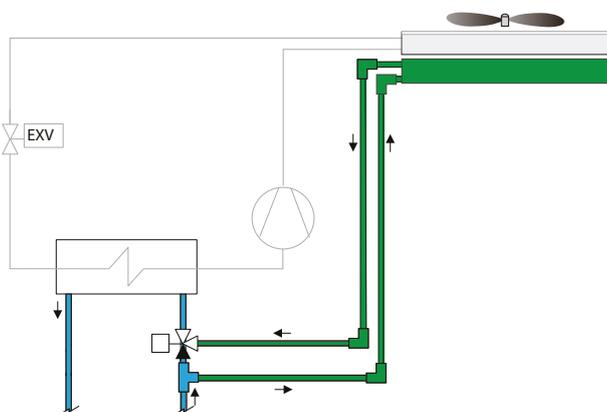
Работа фрикулинга при низкой температуре окружающей среды обеспечивается теплообменником фрикулинга + трехходовым вентилем с электроприводом.
