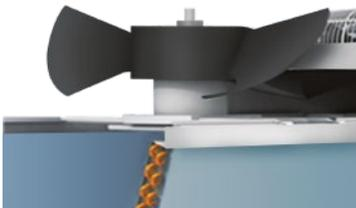
Вентиляторы соединены с защищенным от атмосферных воздействий двигателем прямым приводом, что обеспечивает долговую и надежную их работу. Приводной двигатель проходит статическую и динамическую балансировку и оснащается необслуживаемыми подшипниками для установки вне помещений. Класс безопасности двигателя IP 54 также обеспечивает длительную эксплуатацию вне помещений.
