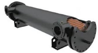
Теплообменник непосредственного кипения кожухотрубного типа. Съемные торцевые крышки позволяют получить доступ к трубкам конденсатора. Хладагент перемещается по трубам, вода подается внутрь стального кожуха с установленными в нем перегородками из гальванизированной стали. Благодаря такой конструкции не возникает проблем с возвратом масла, гарантируется высокая надежность работы компонентов холодильного контура. Изолирующее покрытие толщиной 20 мм обеспечивает снижение теплопередачи.
