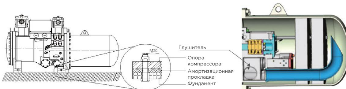
Схема монтажа амортизационной прокладки
