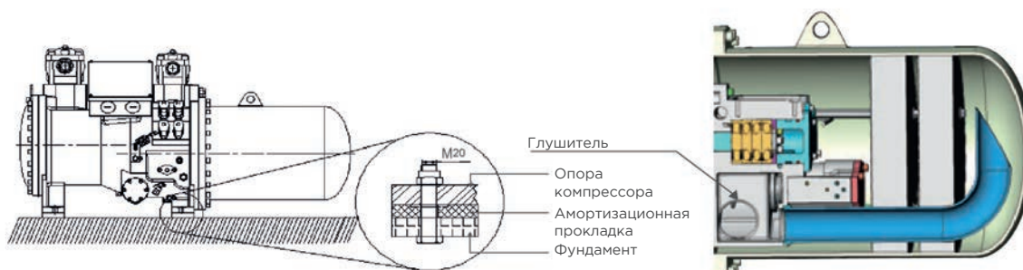
Схема монтажа амортизационной прокладки
