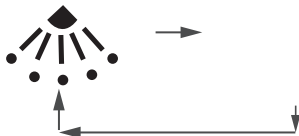
Рис. 38. Последовательность регулировки горизонтальной жалюзи
