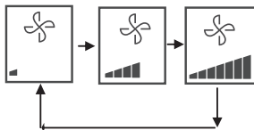
Рис. 28. Последовательность переключения 3 скоростей вращения автоматического вентилятора HRV.
