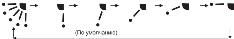
Рис. 37. Последовательность регулировки вертикальной жалюзи
