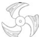
Лопастей, разработанные Midea, с высоким статическим давлением
