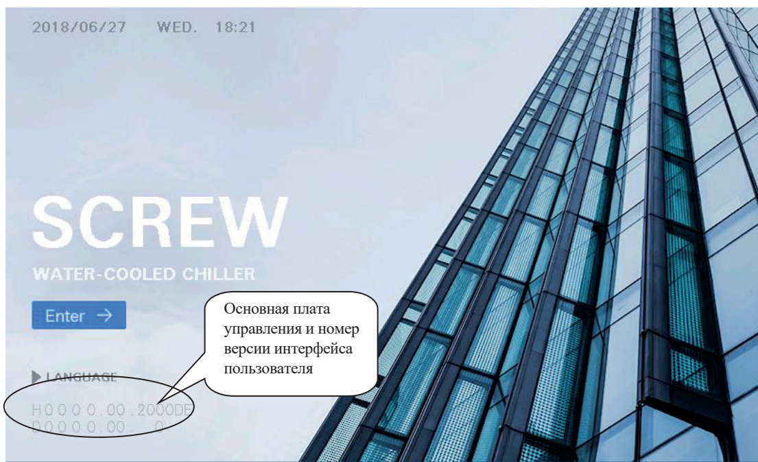
Рисунок 10.1 (Примечание: Способ отображения на дисплее может отличаться для разных устройств) Нажмите на поле «Enter», чтобы перейти к интерфейсу ввода пароля, как показано на Рисунке 10.2.
